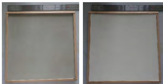
図 3 試験体（左：並大津壁、右：しっくい壁）
